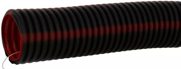
conduit tpc tube pour canalisation  $\varnothing$ 75mm petite longueur avec tire-fils pour courants forts - ik10 ip68 (ip30 avec manchon) non ignifugé noir à bandes rouges - conforme à la norme nf en 61 386-24 et nf en 50 086.2-4
