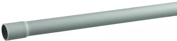
conduit rigide tulipé irl 3321 diamètre 32mm ip68 ik07 longueur 3m en polychlorure de vinyle gris ral7035 pour pose en saillie ou encastré, en résidentiel ou en tertiaire - bonne tenue aux uv et non propagateur de la flamme
