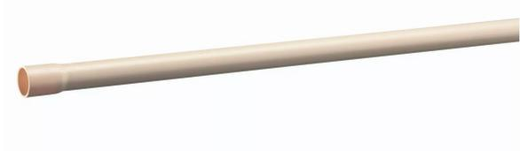
conduit rigide tulipé irl 3321 diamètre 16mm ip68 ik07 longueur 3m en polychlorure de vinyle sable ral1015 pour pose en saillie ou encastré, en résidentiel ou en tertiaire - bonne tenue aux uv et non propagateur de la flamme
