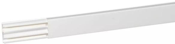
moulure stop-fils dplus avec cloison centrale 40x12,5mm avec 2 compartiments - longueur 2,1m - blanc - ip40 - équipée d'un dispositif de maintien de câbles intégrés - conforme à la norme nf en 50085-2-1
