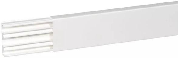
moulure dplus avec cloisons centrales 75x20mm avec 3 compartiments - longueur 2,1m - blanc - ip40 - permet une distribution séparée des courants forts et des courants faibles - conforme à la norme nf en 50085-2-1
