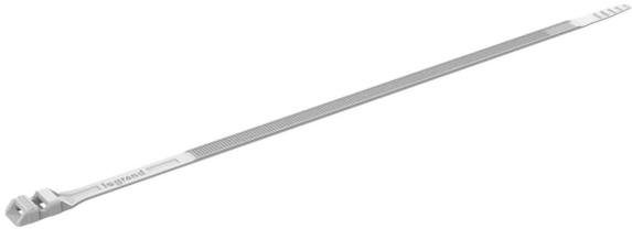
collier colson gris ral7035 pour usage intérieur à denture extérieure largeur 9mm et longueur 357mm diamètre 26mm à 92mm - conforme à la norme en 62275 type1
