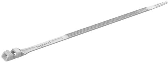
collier colson gris ral7035 pour usage intérieur à denture extérieure largeur 9mm et longueur 262mm diamètre 26mm à 62mm - conforme à la norme en 62275 type1
