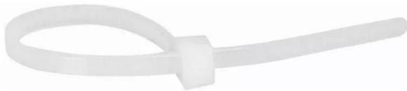
collier colring incolore à tête auto-bloquante à denture intérieure largeur 3,5mm et longueur à plat 140mm - diamètre de serrage de 1,6 à 33mm - conforme à la norme en 62275 (nfc 68-146)
