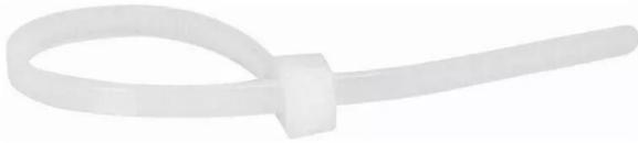
collier colring incolore à tête auto-bloquante à denture extérieure largeur 2,4mm et longueur à plat 105mm - diamètre de serrage de 1,6 à 22mm - conforme à la norme en 62275 (nfc 68-146)
