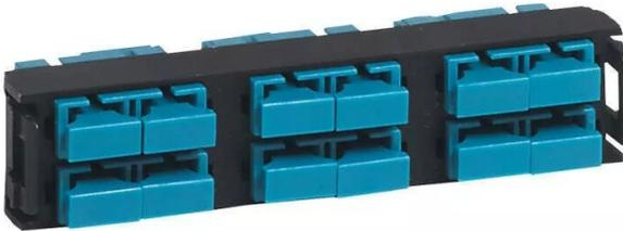
bloc fibre optique lcs<sup>3</sup> sc duplex haute densité pour 12 fibres multimode (62,5µm et 50µm/125µm) - noir - se clipse directement sur le tiroir optique à équiper ou sur la cassette fibre optique à splicer
