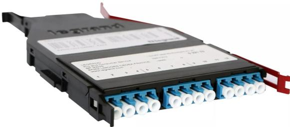
cassette slim haute densité mtp (compatible mpo) pour panneau modulaire lcs<sup>3</sup> os2 monomode (9/125 μm) - 12 brins lc os2 polarité universelle
