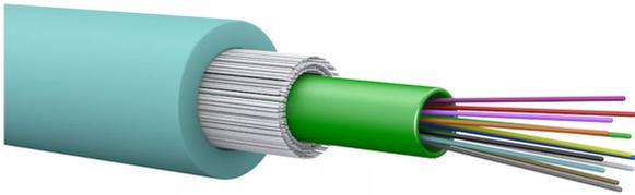
câble optique om4 multimodes à structure libre lcs<sup>3</sup> pour intérieur ou extérieur (mèches de verre) 12 fibres - euroclasse cca - pour installation monomode 50?m/125?m - insensible aux courbures - couleur aqua - livré sur touret (2000m)
