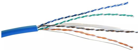
câble cuivre 4 paires torsadées 100ohms grade 2 pour réseaux locaux multimédia et système lcs<sup>3</sup> catégorie 6 f/utp euroclasse dca - gaine Isoh sans halogène 305m - conforme à la nouvelle réglementation rpc - livré en boîte carton 15kg
