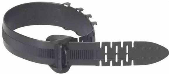
collier à témoin de serrage largeur 15mm et longueur 320mm ø de serrage maximum de 50 à 80mm - avec système d'alerte breveté pour éviter le serrage excessif des câbles - débrayables par pincement de la tête du collier
