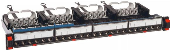
panneau de brassage droit 19pouces 1u lcs<sup>3</sup> catégorie 6 équipé de 24 connecteurs rj45 ftp poe++ avec 4 cassettes de 6 connecteurs - guide-câbles à l'arrière pour maintien du câble lors de la maintenance - extraction automatique des cassettes
