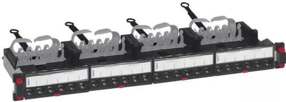
panneau de brassage droit 19pouces 1u lcs<sup>3</sup> cat. 6a équipé de 24 connecteurs rj45 utp poe++ avec 4 cassettes de 6 connecteurs - guide-câbles à l'arrière pour maintien du câble lors de la maintenance - extraction automatique des cassettes
