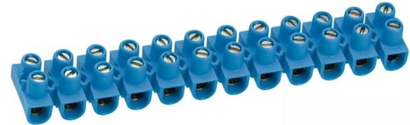
barrette de connexion nylbloc avec capacité assignée 10mm<sup>2</sup> - trou diamètre 4,5mm - intensité maximum 57a - 12 éléments à vis imperdables livrée vis dévissées - tenue au fil incandescent 850°C suivant en 60695-2-11 - bleu
