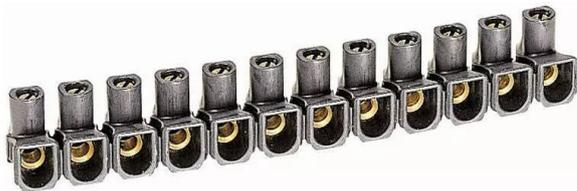
barrette de connexion hypo avec capacité assignée 4mm<sup>2</sup> pour 2 conducteurs - trou diamètre 5mm - intensité maximum 32a - 12 éléments à vis imperdables livrée vis dévissées - tenue au fil incandescent 960°C suivant en 60695-2-11 - noir
