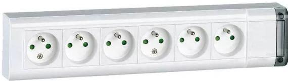
bloc multiprise avec 6 prises de courant 2p+t pour fixation au mur, mobile ou à associer avec une moulure grâce aux embouts livrés - longueur 343mm - à câbler
