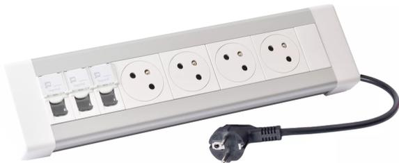
bloc bureau avec corps aluminium et embouts plastique blanc, équipé de 4 prises 2p+t surface et 3 prises rj45 catégorie 6 ftp muni d'un cordon longueur 3m avec fiche 2p+t et prises rj45 à câbler
