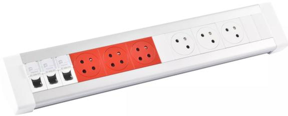
bloc bureau avec corps aluminium et embouts plastique blanc, équipé de 3 prises surface, 3 prises surface à détrompage et 3 prises rj45 catégorie 6 ftp à câbler - raccordement des courants forts sur borniers avec serre-câbles
