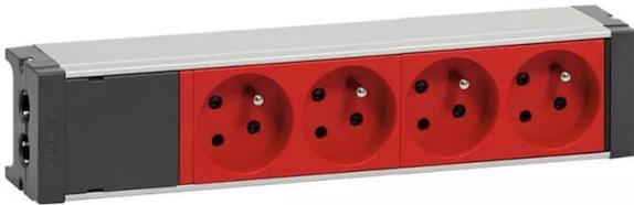
bloc nourrice équipé de 4 prises 2p+t à détrompage avec puits inclinés à 35° - 16a 250v~ équipées d'éclips de protection à câbler avec cuve en aluminium ip20 ik07 - conforme à la norme nf c 61-314
