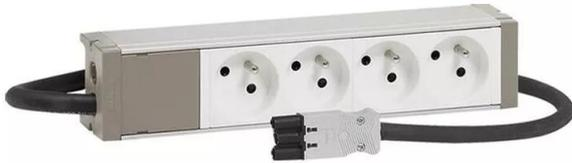
bloc nourrice équipé de 4 prises 2p+t avec puits inclinés à 35° - 16a 250v~ équipées d'éclips de protection et d'un cordon à raccordement rapide 5m - cuve en aluminium ip20 ik07 - conforme à la norme nf c 61-314
