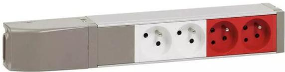
bloc nourrice à connecter équipé de 2 prises 2p+t et 2 prises 2p+t à détrompage avec puits inclinés à 35° et éclips de protection - câblé et livré avec connecteur à raccordement rapide mâle - ip20 ik07 - conforme à la norme nf c 61-314
