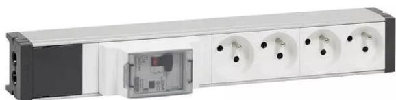
bloc nourrice équipé de 4 prises 2p+t avec puits inclinés à 35° - 16a 250v~ équipées d'éclips de protection et 1 disjoncteur différentiel ph+n 16a 30ma avec cuve en aluminium ip20 ik07 à câbler - conforme à la norme nf c 61-314
