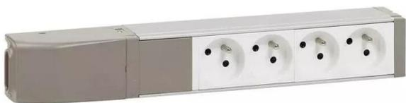
bloc nourrice à connecter équipé de 4 prises 2p+t 16a 250v~ avec puits inclinés à 35° et éclips de protection - câblé et livré avec connecteur à raccordement rapide mâle encastré dans l'embout - ip20 ik07 - conforme à la norme nf c 61-314
