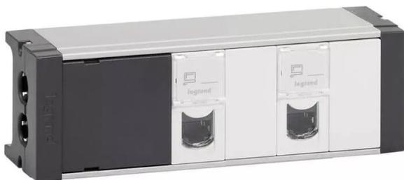
bloc nourrice à câbler équipé de 2 prises rj45 catégorie 6 ftp 1 module et 2 obturateurs 1 module avec cuve en aluminium ip20 ik07 - conforme à la norme nf c 61-314
