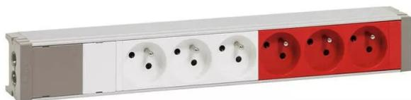
bloc nourrice équipé de 3 prises 2p+t et 3 prises 2p+t à détrompage avec puits inclinés à 35° - 16a 250v~ équipées d'éclips de protection à câbler avec cuve en aluminium ip20 ik07 - conforme à la norme nf c 61-314
