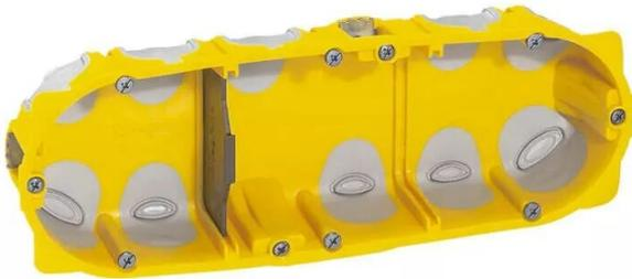
boîte multipostes ecobatibox 3 postes 6 à 8 modules profondeur 40mm pour montage d'appareillage à vis - livrée avec 1 cloison de séparation amovible - pour utilisation horizontale ou verticale - étanchéité à l'air renforcée
