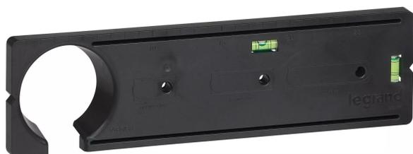
gabarit de pose batibox pour boîte à encastrer pour le repérage et le découpage des plaques de plâtres en configuration multipostes à partir d'un trou existant  $\varnothing 65\text{mm}$  à  $\varnothing 67\text{mm}$  - niveau à bulle intégré
