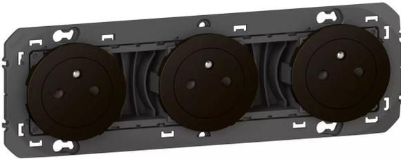
triple prise de courant 3x2p+t surface précâblées dooxie 16a 230v~ à raccordement par bornes automatiques - livrée avec support et enjoliveur noir, à équiper de plaque de finition
