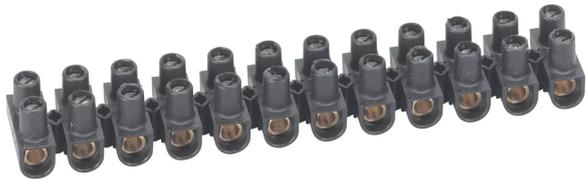
barrette de 12 bornes de raccordement à vis nylbloc capacité 25mm<sup>2</sup> intensité maximale de 101a, tension d'isolement de 250v selon en 60998-2-1, tenue au fil incandescent à 850° - noir
