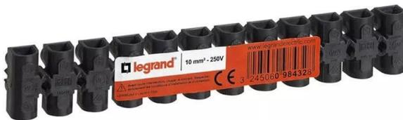
barrette de 12 bornes de raccordement à vis nybloc capacité 10mm<sup>2</sup> intensité maximale de 57a, tension d'isolement de 250v selon en 60998-2-1, tenue au fil incandescent à 850° - noir
