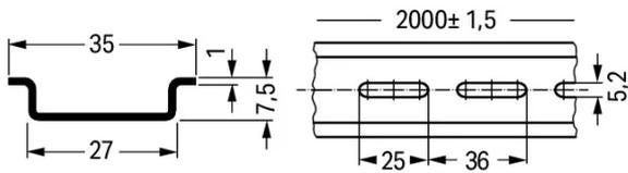
Rail acier 35 x 7,5 mm , épaisseur 1 mm, perforé, lg 2 m
