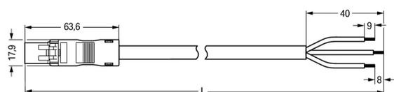
Câble de raccordement précâblé Eca connecteur mâle/extrémité libre, blanc
