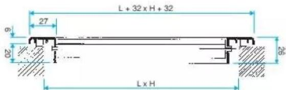
grille murale simple déflexion (reprise) sc 101 - acier avec peinture époxy blanc ral9010 30% - fixation f3 non apparente par clips à friction - 500x150 mm - ailettes verticales mobiles, réglables individuellement, espacées de 20 mm
