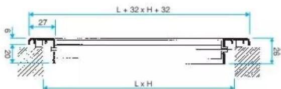
grille murale double déflexion (soufflage) sc 102d - acier blanc ra19010 30% - fixation f3 non apparente par clips à friction - 800x200 mm - ailettes horizontales arrière et verticales avant réglables individuellement, espacées de 20 mm
