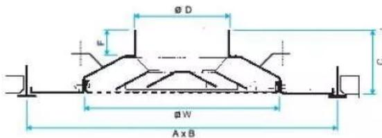
diffuseur de soufflage isolé carré à tôle perforée ouvrante sc310r - d315 - 562x562 (pour dalle 600x600) - 1 à 4 voies grâce déflecteurs réglables individuellement - acier peint époxy blanc ral9010 30% - fixation non apparente avec 3 pattes
