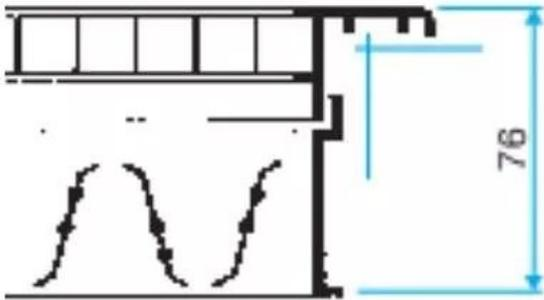
registre rectangulaire de réglage de débit sgs en acier galva à mouvement contrarotatif - pour grilles murales sc et ac - 1000x600 mm - réglage depuis la face de la grille grâce à un tournevis - fixation sur la grille au moyen de clips en s
