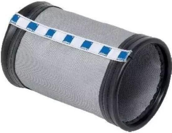
manchette souple ms pro m0 - diamètre 355 mm - intègre un raccord femelle rigide à chaque extrémité et un joint d'étanchéité - permet la désolidarisation entre les liaisons ventilateur-réseau ou réseau-réseau
