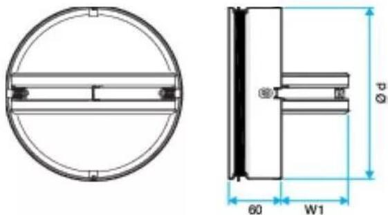
cartouche coupe-feu cf2 - diamètre 100 - ei120s - élément à insérer dans un conduit aéraulique en partie terminale
