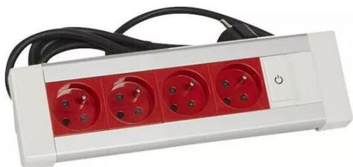
bloc bureau équipé de 4 prises 2p+t à détrompage avec éclips de protection et 1 interrupteur lumineux - équipé d'un cordon 3m muni d'une fiche 2p+t - aluminium anodisé - conforme à la norme nf c 61-314
