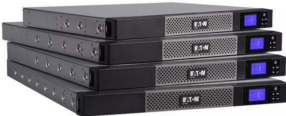
Protection d'équipements informatiques professionnels (réseau, serveur, stockage), Onduleur 5P, 1150VA, 700W, line-interactive, rack 1U, 10mins d'autonomie à 50% de charge, entrée C14, sortie 6 (C13), garantie 3 ans
