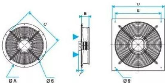
ventilateur helica 300 - 1500 t/min - virole ronde v2 - ventilation des locaux tertiaires ou habitat ( parc de stationnement) sans besoin de classement au feu - moteur à rotor extérieur ip 44 classe f avec variation de vitesse possible
