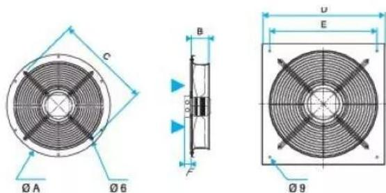
ventilateur helica 250 - 1500 t/min - virole ronde v2 - ventilation des locaux tertiaires ou habitat ( parc de stationnement) sans besoin de classement au feu - moteur à rotor extérieur ip 44 classe f avec variation de vitesse possible
