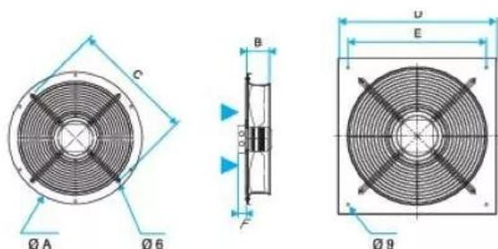
ventilateur helica 250 - 2800 t/min - platine carrée v2 - ventilation des locaux tertiaires ou habitat ( parc de stationnement) sans besoin de classement au feu - moteur à rotor extérieur ip 44 classe f avec variation de vitesse possible
