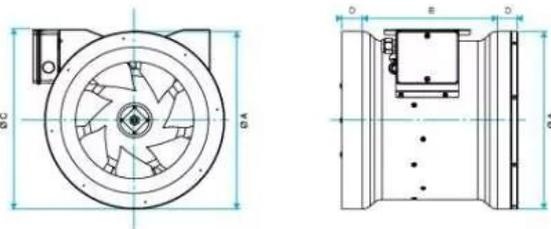
ventilateur de conduit vc 250 v2 - extraction/insufflation d'air en réseau de gaines circulaires pour locaux tertiaires - corps en tôle galvanisée avec piquage en ligne - moteur avec rotor extérieur monophasé 230 v - 50 hz - ip 44
