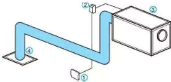
capteur de co2 et température - 0-2000ppm - 0-50°C - signal de sortie 0-10 v - alimentation 24 v - autocalibration - hauteur d'installation entre 1,5 et 3,5 m - installation murale
