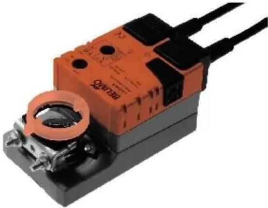
servomoteur belimo nm 230a tout ou rien sans ressort de rappel 3 points - 10 nm - ac 230v - temps de course 150 s / 90° - ip54 - raccordement câble 1 m pvc - sens rotation sélectionnable
