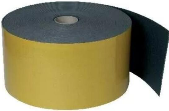
joint de traversée de dalle adhésif en rouleau - rouleau de 25 m - largeur 220 m - désolidarisation des conduits et des dalles ou murs - permet d'amortir les vibrations solidiennes
